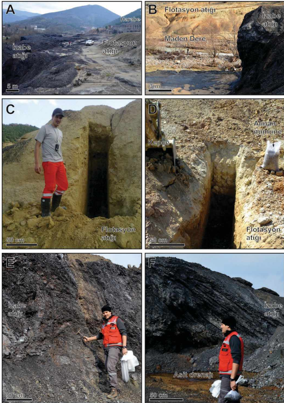
Şekil 5. Koordinatlandırma ve örnekleme işlemleri. A) İzabe atıklarının GPS ile koordinatlandırma işlemi, B) Maden dere her iki tarafında izabe ve flotasyon atıkları, C, D) Flotasyon atıklarında kepçe ile yarma açma ve örnekleme işlemi, E, F) İzabe atıklarında örnekleme işlemi.
